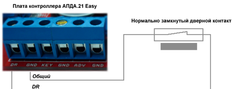
Рисунок 5 – Схема подключения дверного контакта
