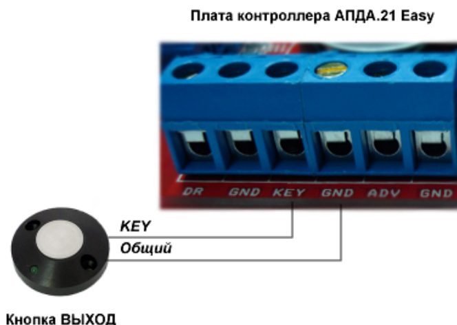
Рисунок 4 - Схема подключения кнопки "Выход"
